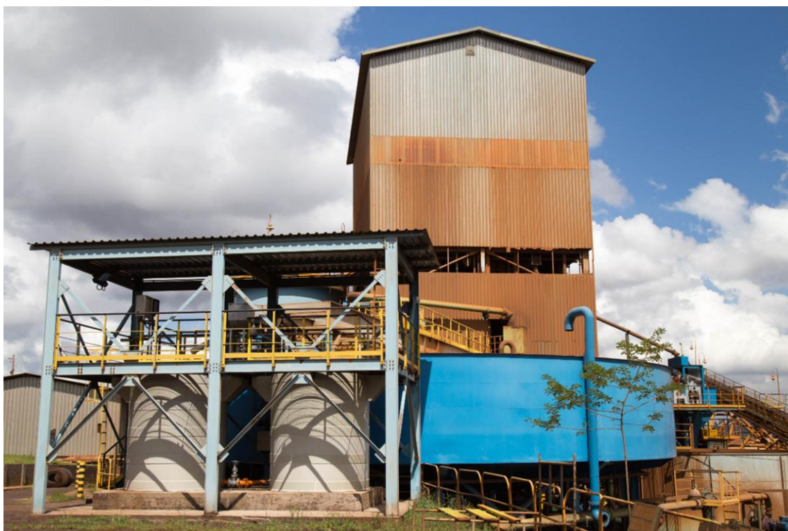
Espessador de rejeitos que será interligado aos filtros para desaguamento do rejeito.
