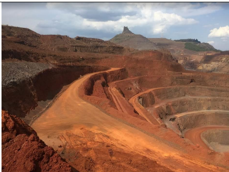
Depósito de argila laterítica de coloração ocre-avermelhada exposta na cava do Retiro do Sapecado e com presença extensiva nesta região.
